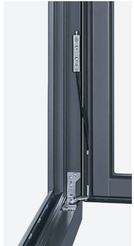
Lastabtragung 185 kg und Ecklager Bandseite TITAN axxent 24 +
